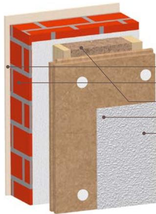
**3.5.8 Putzfassade mit Unterkonstruktion auf Mauerziegel mit  $\lambda$ -Wert = 0,09 W/mK**
