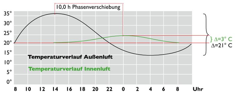
$$\text{Amplitudendämpfung} = \Delta 21^\circ \text{C} / \Delta 3^\circ \text{C} = 7$$
