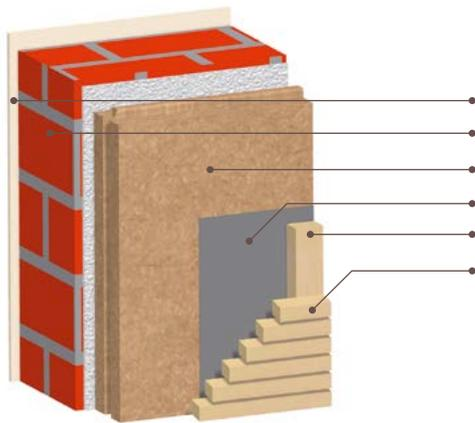
**3.5.2 Hinterlüftete Fassade auf Mauerziegel mit  $\lambda$ -Wert = 0,15 W/mK**
