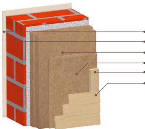
**3.5.3 Hinterlüftete Fassade auf Mauerziegel mit  $\lambda$ -Wert = 0,09 W/mK**
