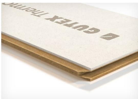
Gutex Thermowall RF ist die druckfeste Holzfaserdämmplatte in Kombination mit einer 10 mm dicken Gipsfaserplatte zum Einsatz bei brennbaren hinterlüfteten Fassadenbekleidungen.
